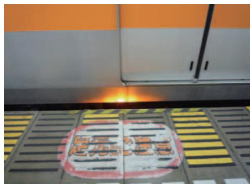
(コラム 14) スロープとくし状ゴムの設置によりホームと車両との段差・すき間を低減した事例
